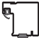
Blockzarge - Einbau vor der Öffnung
